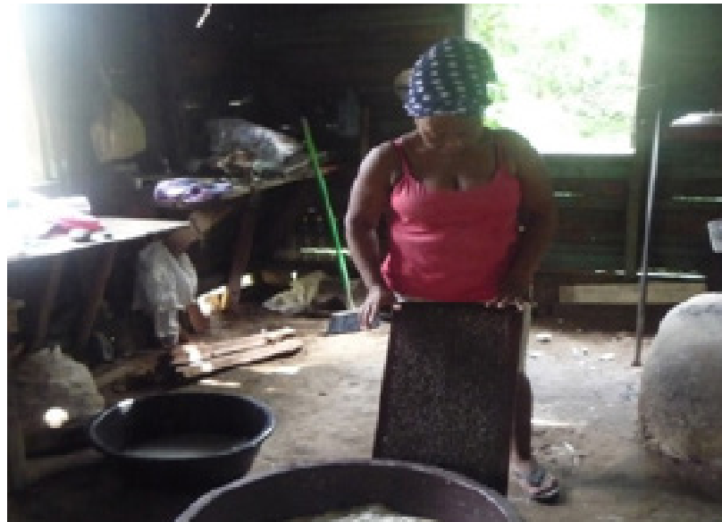
Foto 23: El rallado de la yuca amarga ( Gain Giftu ). La producción del casabe inicia con el rallado de la yuca. En la imagen se muestra un rayador tradicional: consiste en una tabla a la que se le insertan piedras, que funcionan como “raspadoras” de la yuca. Foto tomada el 09/12/2019.
