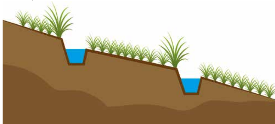
Figura 4. Acequias a nivel o desnivel protegidas con barreras vivas. Fuente: CATIE
