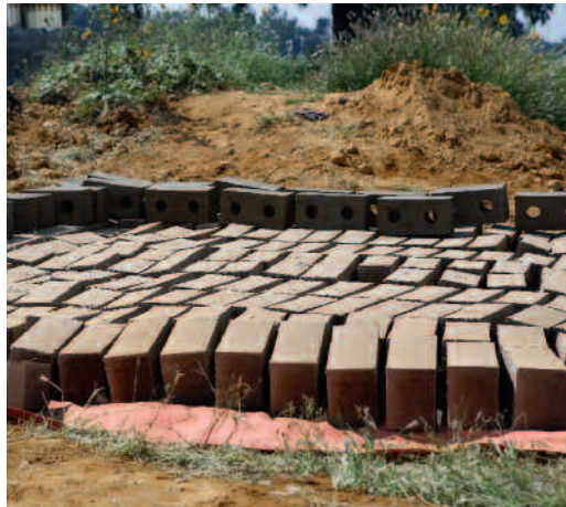
Die Adopress wurde speziell für die Verbesserung der Siedlungsqualität von Armen entwickelt: Sie können die umweltfreundlichen Ziegelsteine aus Lehm, Sand und Kies selber herstellen.
