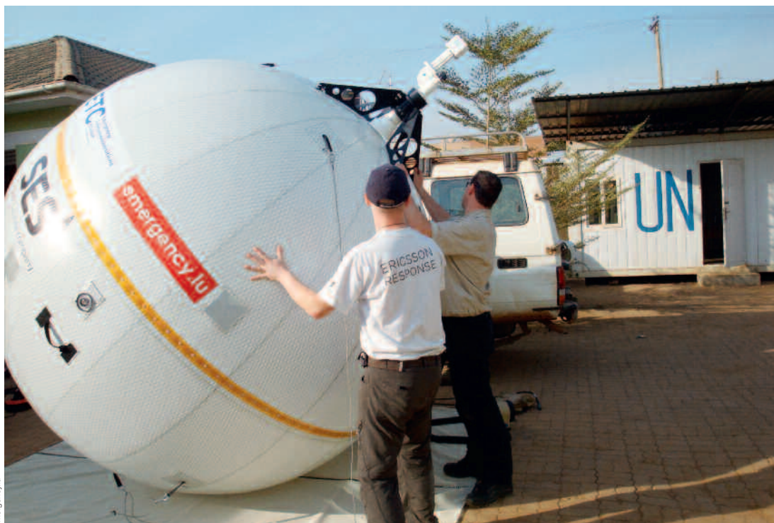
Mobile Internetverbindung für humanitäre Helfer: Die aufblasbare Antenne ist überall in Krisengebieten, wie hier 2012 im Südsudan, innert einer Stunde einsatzbereit.
