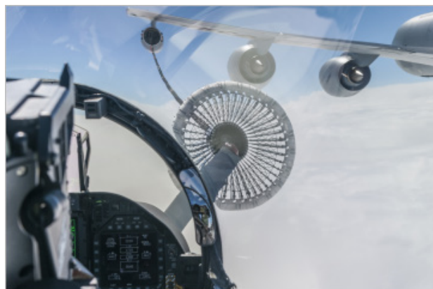
Standardisation nécessaire: F/A-18 suisse ravitaillé en vol par un avion ravitailleur américain (© VBS / © DDPS)
